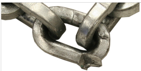
Kättinglänken har mekaniska skador.
